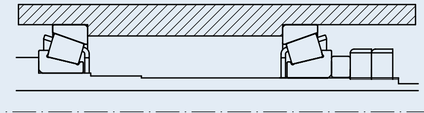
(d) Position preload without spacers
